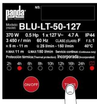
Cuando se presiona el botón del temporizador durante más de diez segundos, la luz indicadora de ciclo único parpadeará y cambiará al modo de ciclo único. En este modo, después de presionar [ON], la bomba funcionará y se detendrá cuando se agote el tiempo configurado, y no volverá a funcionar hasta que se reconecte el suministro de energía. Para cambiar el tiempo de configuración, presione el botón del temporizador (2h, 4h, 6h, 8h, 10h, 12h, 16h, 24h).
