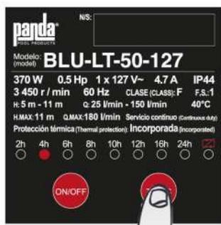
Después de encender la bomba, la configuración predeterminada es de 24 horas de funcionamiento continuo (las luces indicadoras parpadean en 24 h). Para establecer el período de operación deseado, esto se puede hacer presionando el botón del temporizador; las luces indicadoras parpadearán cíclicamente entre 2h, 4h, 6h, 8h, 10h, 12h, 16h y 24h. Luego, presione el botón ON/OFF y la bomba comenzará a funcionar. El tiempo de funcionamiento será el que indique la luz del temporizador.
