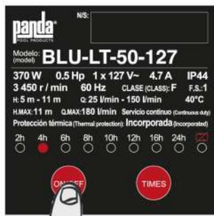
Por ejemplo, si configura el temporizador en 4h y presiona [ON] a las 8:00, la bomba funcionará durante 4 horas y se detendrá a las 12:00, y la luz indicadora dejará de parpadear. La bomba volverá a iniciar su funcionamiento durante 4 horas a las 8:00 del día siguiente.
